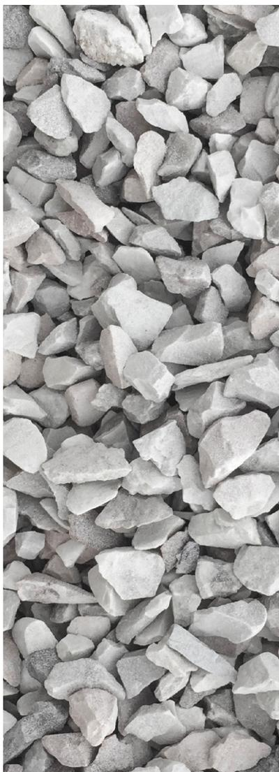
Inerti calcarei estratti da rocce sedimentarie carbonatiche, a secco, frantumati ed accuratamente selezionati.
